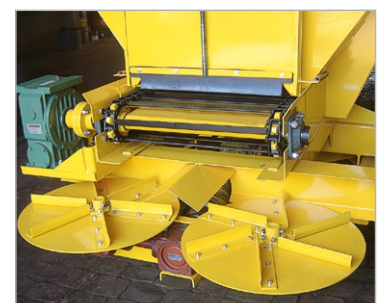
Disco duplo com 630 mm e esteira de 700 mm.
