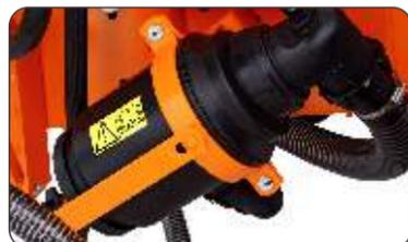
El sistema de filtración del circuito hidráulico de pulverización se compone de un filtro de succión FVS 200, con dos elementos filtrantes de malla de acero inoxidable y cierre rápido, de filtros de línea, uno para cada segmento de las barras de pulverización, de filtros en todos las boquillas, que pueden ser elegidos de acuerdo con el caudal de la boquilla usada.
