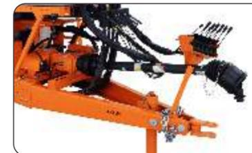
Permite operaciones con ángulos de hasta 75° sin desconectar la TDF del tractor. Mayor facilidad operacional.
