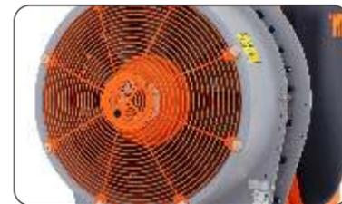
Con 725 mm de diámetro. Tiene paletas de nailon reforzadas con fibra de vidrio, más leves y resistentes a la acción corrosiva de los agroquímicos.
