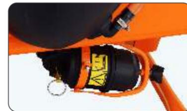
Retiene las impurezas contenidas en el producto y protege los componentes del circuito de pulverización.
