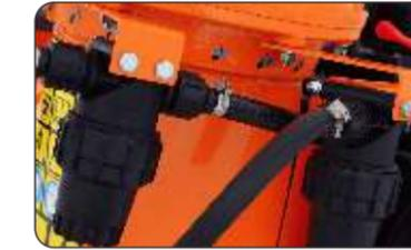
J400 y J 600, el sistema de filtración del circuito hidráulico de pulverización es compuesto por 1 filtro de succión FVS 102, con dos elementos filtrantes de malla de acero inoxidable y cierre rápido. AJ 401, el sistema de filtración del circuito hidráulico de pulverización es compuesto por 2 filtros de línea, uno para cada conducto.
