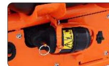
El filtro de succión tiene la función de retener todo y cualquier tipo de impureza antes de que alcancen la bomba de agroquímicos.
